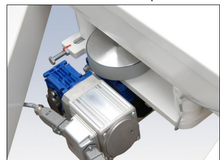
Bürstenloser Antrieb der Reversierung
